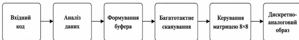
Рис. 1. Узагальнена функціональна схема роботи програми.
