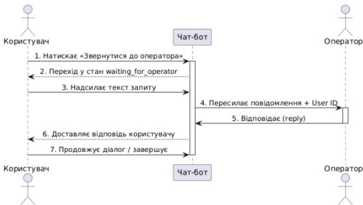
Рис. 1. UML-діаграма послідовності процесу звернення до оператора
