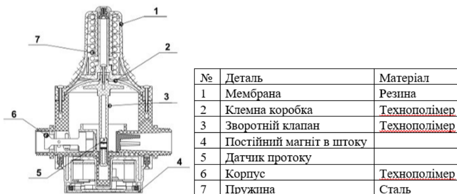
Рис.3. Структурна схема реле тиску Katran
