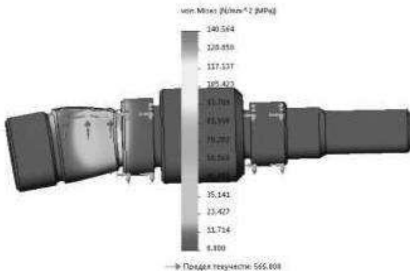
Рис. 2. Вузлові напруження вала водяного насоса (сталь 45)
