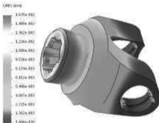
Рис. 3. Переміщення вуха переднього карданного вала
