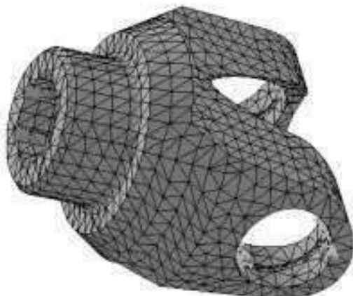
Рис. 1. Сітка вуха переднього карданного вала
