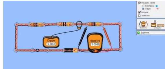
Рис. 4. Вимірювання сили струму та напруги на ділянці кола при послідовному з'єднанні резисторів
