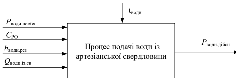
Рис.2. Структурна схема процесу подачі води із свердловини
